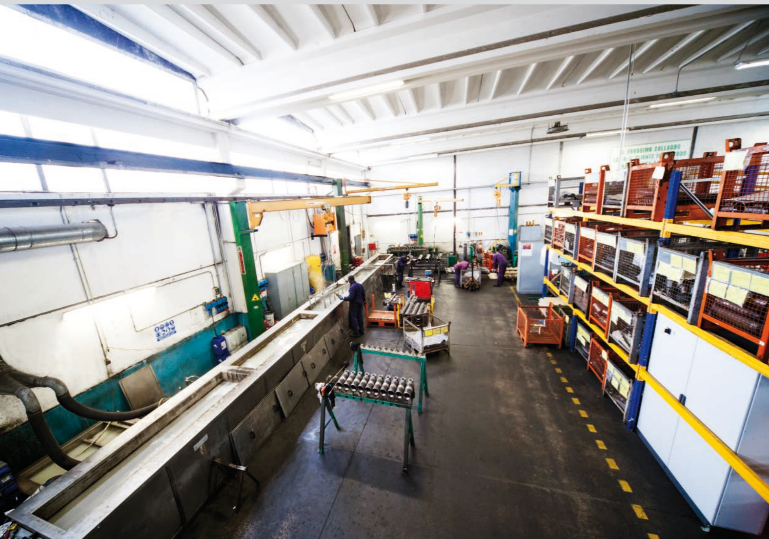
Vasca da 10 Mt per la pulizia ad ultrasuoni di cilindri e componenti Ultrasonic cleaning tank for cylinder tubes and components - length 10 Mt
